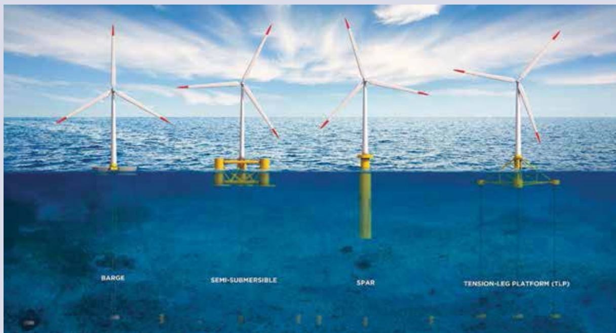
Figure 5 : Catégories de flotteurs - Crédit : South West – Offshore Floating Wind – Design and Installation.
