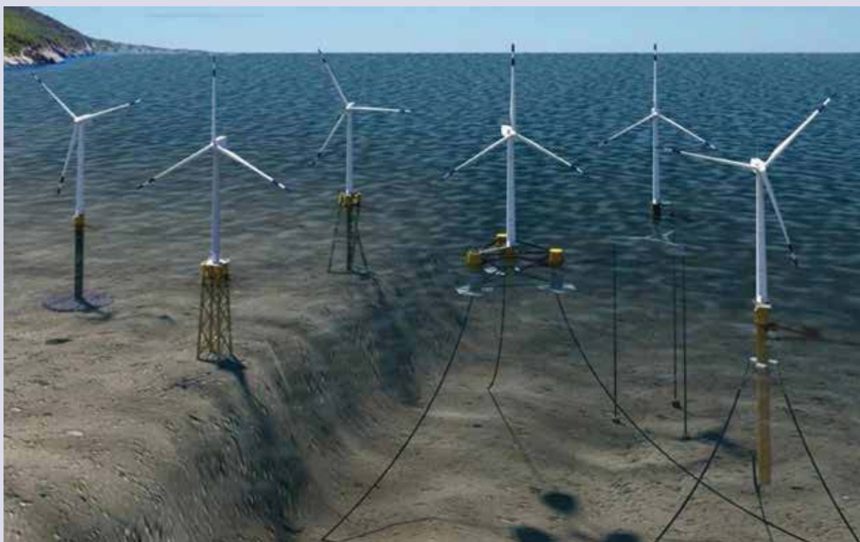
Figure 4 : De l'éolien posé à l'éolien flottant – Crédit : Josh Bauer/NREL – Department of Energy.
